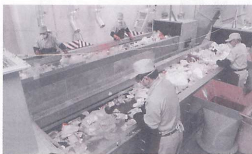
(手選別による異物の抜き取り作業)
